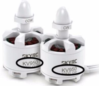
Essa medida indica a quantidade de Rotações por Minuto (RPM) que o motor pode fazer por volt ou seja, RPM/volt. Por exemplo, um motor com 950 KV, se submetido a 1 volt, girará 950 vezes em um minuto.
