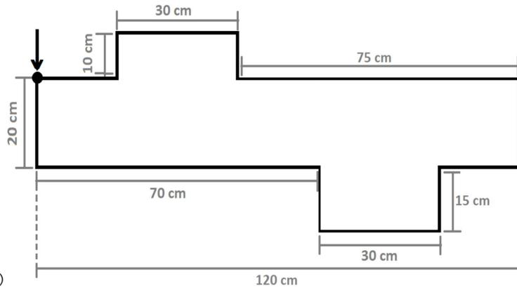
A posição inicial da ferramenta do robô é identificada pela seta na figura. Se a garra se movimenta com velocidade de 2,5 cm/s, utilize os códigos na tabela para indicar ao robô o caminho que a garra deve percorrer para realizar a solda.
