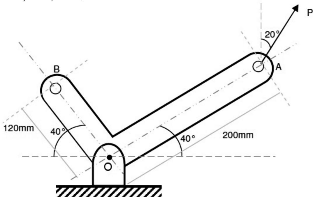
Considerando as componentes vertical e horizontal da força, calcule o momento de P em relação a O para determinar o motor mais adequado para a junta rotativa em O baseado em seu torque nominal.
