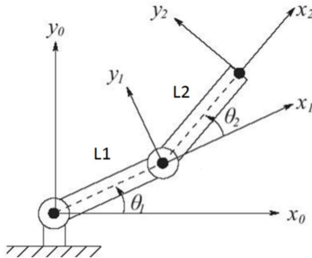
Se as dimensões das juntas podem ser desprezadas,  $L1 = 50\text{cm}$ ,  $L2 = L1/2$ ,  $\theta1 = 30^\circ$  e  $\theta2 = 15^\circ$ , qual a posição  $(x,y)$  do efetuador em relação ao plano cartesiano definido por  $(\vec{x}_0, \vec{y}_0)$ ?
