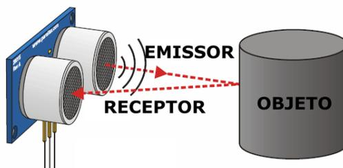
Um sensor de ultrassom foi instalado no robô móvel, responsável pelo transporte de material em uma planta fabril, para que o robô pare ao detectar algum objeto em seu trajeto. Considerando a velocidade do som de 340 m/s, o tempo gasto na leitura pelo sensor para um objeto a 1,70 metros de distância será de:
