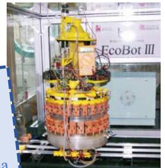
O robô utiliza 48 células de combustível microbiótico que quebram o alimento e extraem os elétrons do processo. Os elétrons alimentam os circuitos de energia. O robô se alimenta de restos de alimentos e os restos de alimentos são excretados a cerca de 10 centímetros de distância. O robô joga fora os resíduos. O robô utiliza apenas 1% do alimento ingerido para se alimentar. A tecnologia verde, e seus criadores esperam que ela permita melhor os alimentos.
